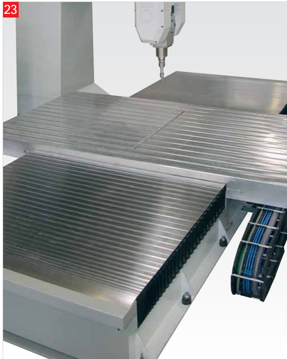
TA Tavolo in alluminio scanalato Aluminium table with grooves Table en aluminium cannalè Mesa en aluminio acanalada Aluminiumtisch mit T-Nut
