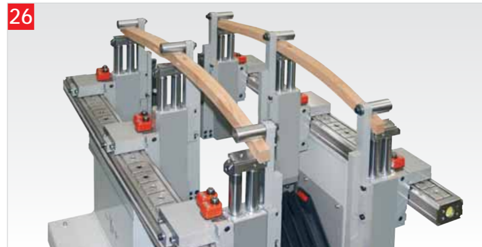
PR Pressanti regolabili in altezza Adjustable clamps in hight Presseurs réglables en hauteur Spanner einstellbar in Höhe Prensares regulables en altura
